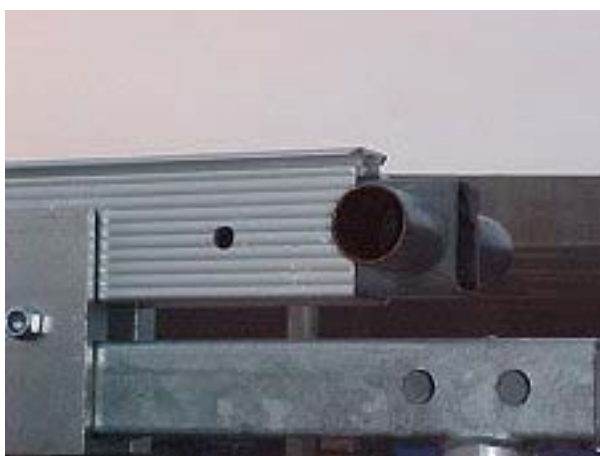
I modsatte ende monteres endebeslag samt rør.
